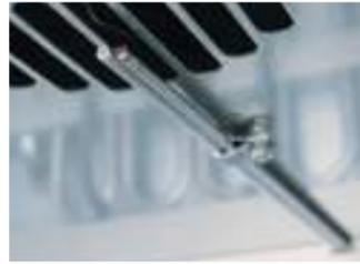
Sensores de temperatura multi-conductores
