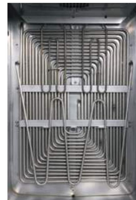
la temperatura prácticamente constante. La humedad condensa en el serpentín de refrigeración y el agua condensada retorna al generador de vapor, donde la bomba la expulsa al desagüe. Gracias a este sistema eficiente, CLIMACELL® EVO alcanza muy rápido incluso los valores de humedad relativa más bajos.
