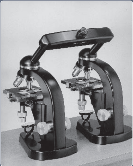
Microscopio de comparación con monocular, Ernst Leitz Wetzlar, año de construcción 1955
