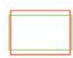
El Leica DMS300 ofrece una vista en detalle de la imagen en formato 16:9 (indicada mediante un marco verde) para la imagen en vivo en un monitor HD. Las capturas siempre se almacenan en formato 4:3 (indicado mediante un marco rojo).
