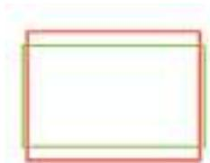
El Leica DMS1000 ofrece una vista en detalle de la imagen en formato 16:9 (indicada mediante un marco verde) para la imagen en vivo en un monitor HD. Las capturas siempre se almacenan en formato 4:3 (indicado mediante un marco rojo).
