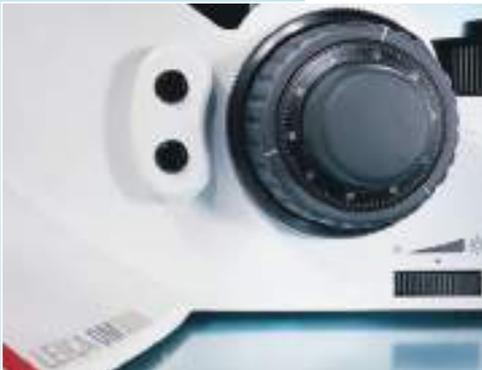
**Adaptación automática de la iluminación con cada cambio de objetivo:** al cambiar de objetivo, el microscopio Leica DM3000 adapta automáticamente la intensidad luminosa a la necesidad de luz del nuevo cambio de aumentos. Los últimos valores de luz ajustados se almacenan para cada objetivo. El brillo subjetivo percibido por el observador es siempre constante y así se evitan cambios bruscos en la intensidad luminosa, lo que permite un trabajo prolongado sin que se cansen los ojos.
