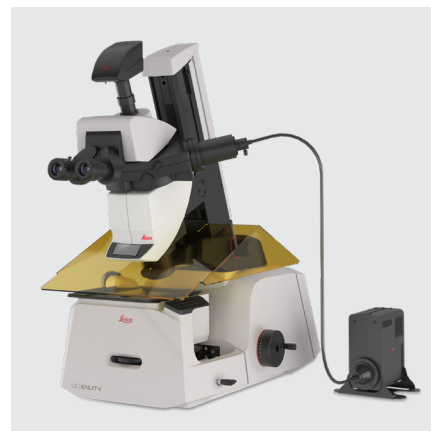
Fluorescencia criogénica: UC equipada con cámara criogénica y lupa para focalizar la fluorescencia en condiciones criogénicas
