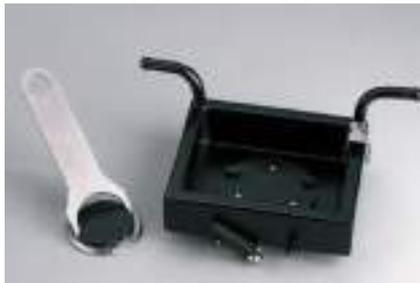
La cubeta del tampón opcional con dos paredes está disponible en dos tamaños distintos, que permiten la obtención de secciones de muestras de 33 x 40 mm o incluso de 70 x 40 mm.
