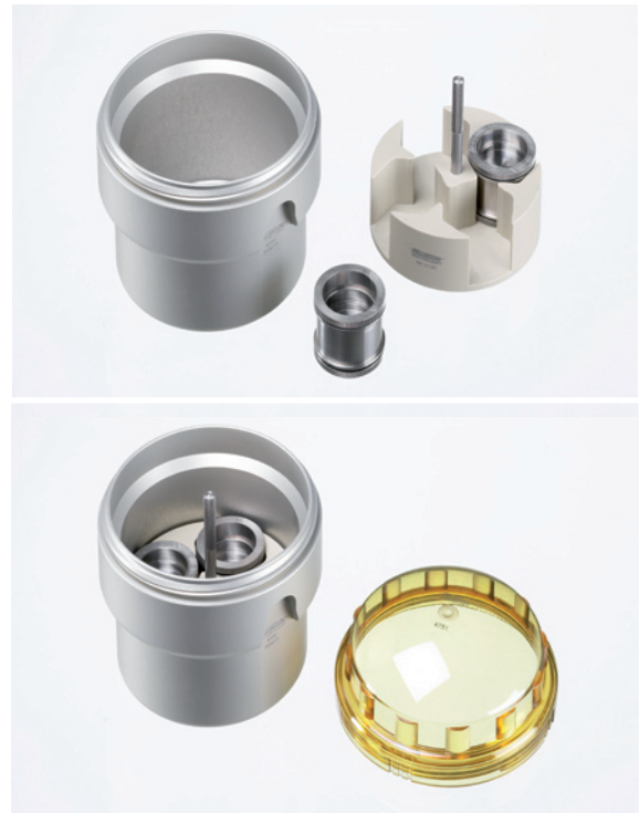
Soporte 4750 con tapa 4751 y el accesorio especial para la determinación de la capacidad de retención del agua.
