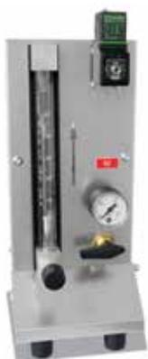
Sistema de gasificación para gases protectores o reactivos no inflamables, con llave de paso y caudalímetro con válvula reguladora, tubos montados, listo para la conexión
